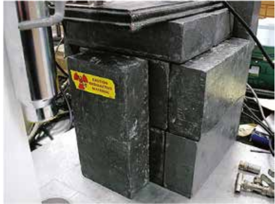
სურათი 9.2. რადიოაქტიურ მასალებისაგან დამცავი მყარი მასალის ბარიერი
